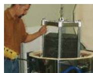
Placer dans le four pour délanter et infiltrer
